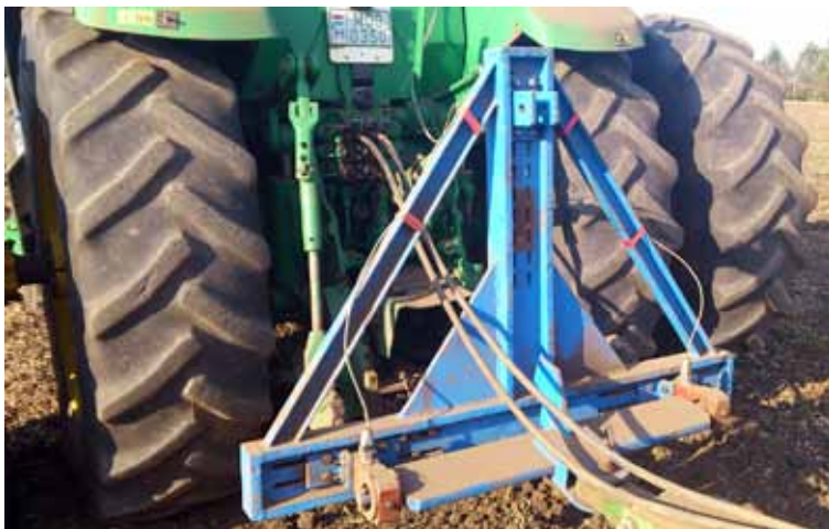
Obr. 4) Mechanická časť meracieho zariadenia ťahového odporu.
